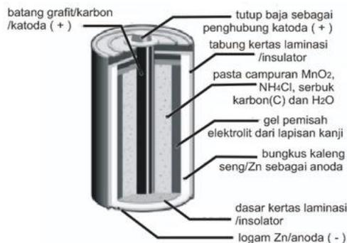
Gambar 1. Bagian-bagian dalam baterai
