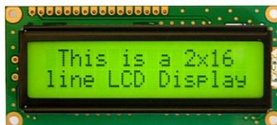
Gambar 2. 7. LCD 16x2
