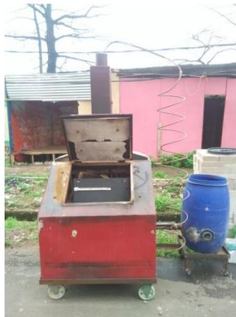
**Gambar 3.15 Setelah Dipasang Pipa Kondensasi Spiral**
