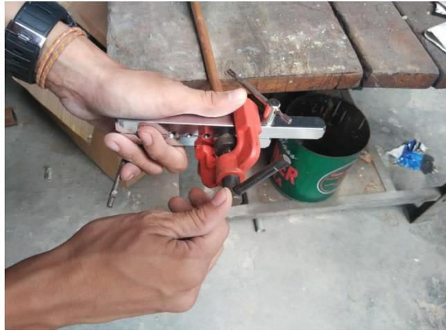
**Gambar 2.6. Proses *flaring* menggunakan *flare block***
