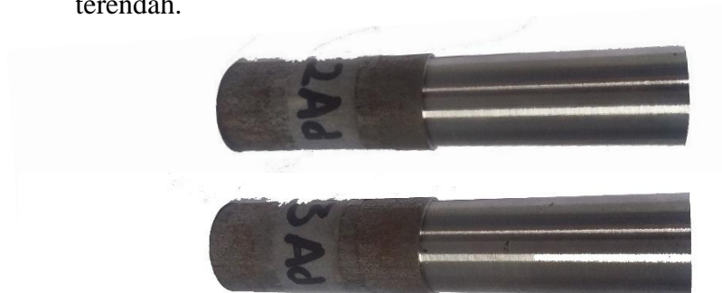
Gambar 4.8 Hasil pemesinan dengan parameter r_e 0.4 mm dan V_c 190 m/min Sumber. Dokumentasi Pribadi
