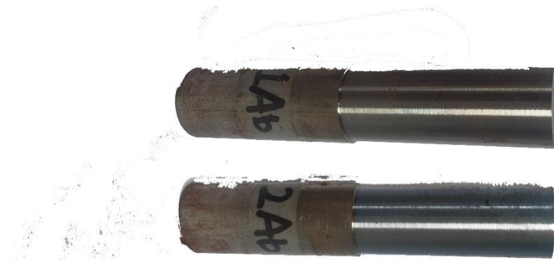
Gambar 4.4 Hasil pemesinan dengan parameter r_e 0.4 mm dan V_c 160 m/min
