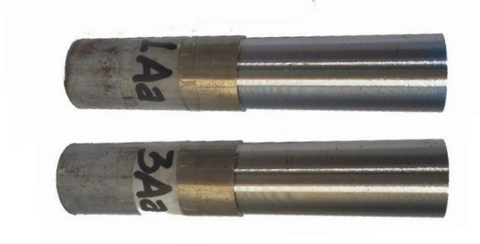
Gambar 4.2 Hasil pemesinan dengan parameter r_e 0.4 mm dan V_c 145 m/min
