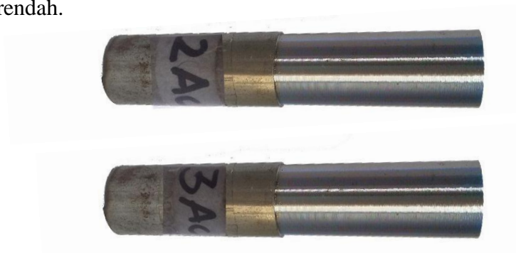
Gambar 4.6 Hasil pemesinan dengan parameter r_e 0.4 mm dan V_c 175 m/min
