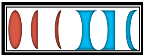
Gambar 4. Lensa konvergen dan divergen, digambarkan dalam bentuk penampang lintang Sumber: Fisika Edisi Kelima, Jilid 2 Douglas C. Giancoli Terjemahan
