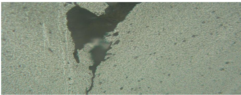
Struktur Mikro crack pada sambungan las friction
