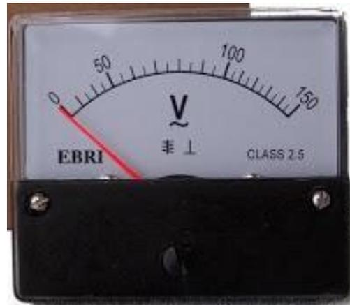
**Gambar 2.10 Voltmeter<sup>24</sup>**
