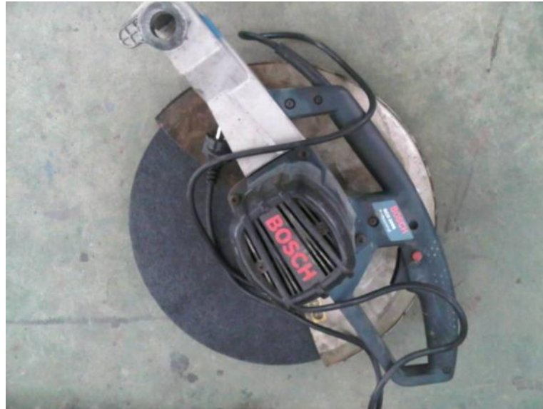
Gambar 3.6 Mesin gerinda potong
