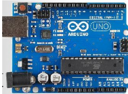
Gambar 2.6. Bentuk fisik Arduino Uno
