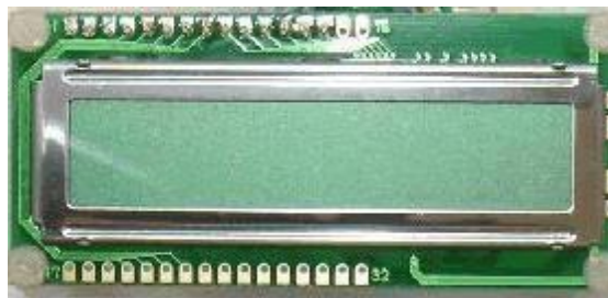
Gambar 2.6 Modul LCD karakter 2x16
