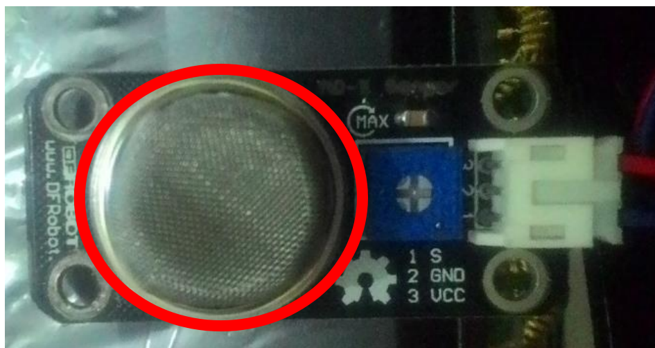
Gambar 4.10 Rangkaian Sensor Gass di Perangkat Keras Rangkaian
