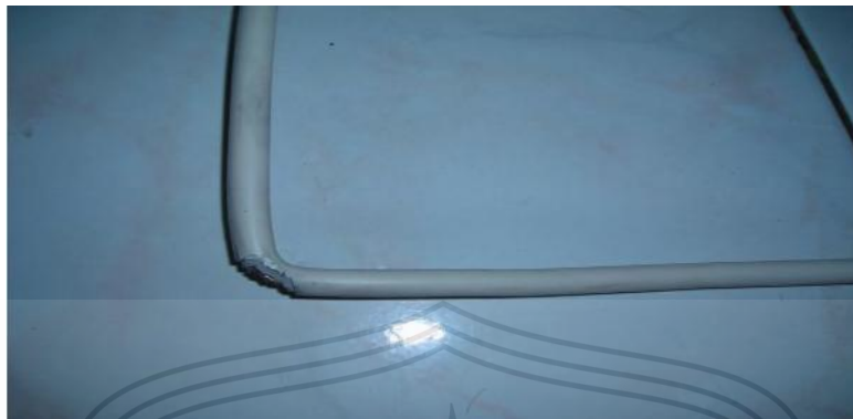
Gambar 4.5 Sampel kabel ditekuk 90 derajat
