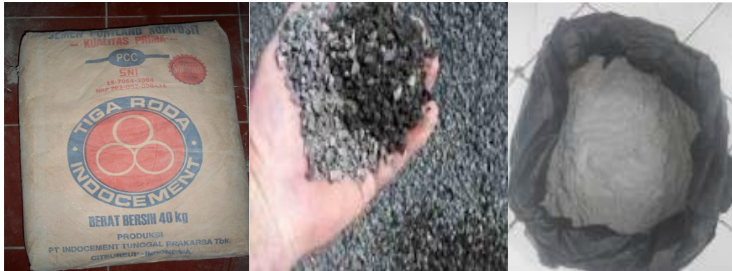
Gambar : 4.1 Semen (kiri), Pasir (Tengah), Abu Tempurung Kelapa (kanan). (Foto Dokumen Pribadi)
