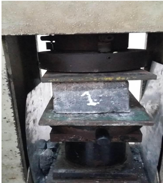
Proses penekanan dengan mesin Kuat Tekan
