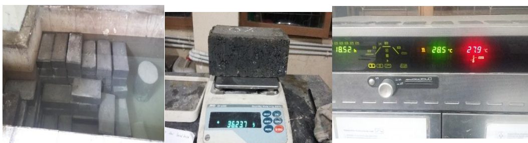
Gambar : 4.4 Perendaman (kiri), Penimbangan Berat Basah (Tengah), Pengovenan Paving Block (kanan) (Foto Dokumen Pribadi)
