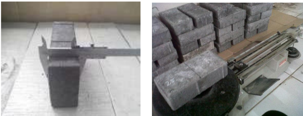
Gambar : 4.2 Pengujian Ukuran Fisik ( kiri ) dan Penimbangan Berat Paving Block (kanan). (Foto Dokumen Pribadi)
