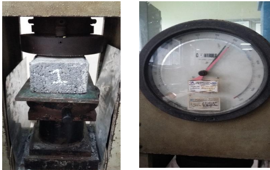
Gambar : 4.6 Proses Pengujian Kuat Tekan Paving Block
