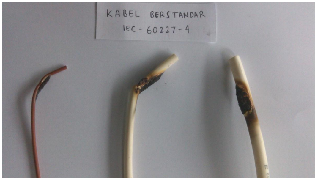
Gambar Hasil Uji Bakar Bagian Isolator, Pembungkus Inti Dan Selubung Luar Kabel NYM 3x1,5 mm 2 (Re) Berstandar IEC 60227 – 4
