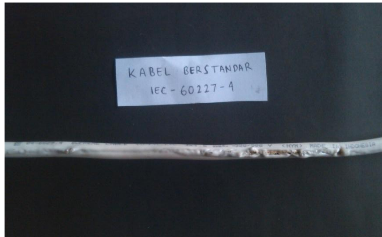
Gambar 4.2 Kabel Berstandar IEC 60227 – 4 Setelah Dialiri Arus 76 Ampere
