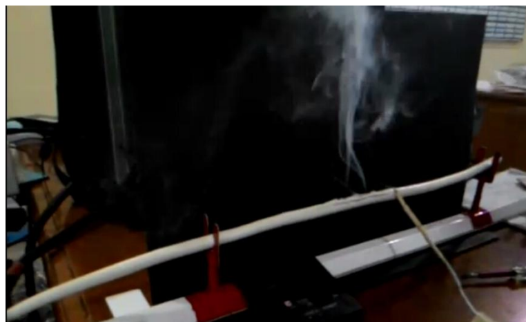
Gambar 4.1. Perubahan Fisik Kabel Berstandar IEC 60227 – 4 Ketika Dialiri Arus 76 Ampere
