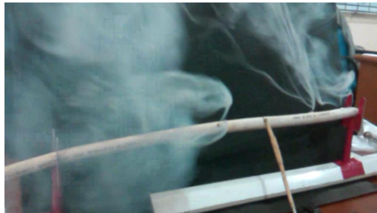
Gambar 4.3 Perubahan Fisik Kabel Tidak Berstandar IEC 60227 – 4 Ketika Dialiri Arus 76 Ampere
