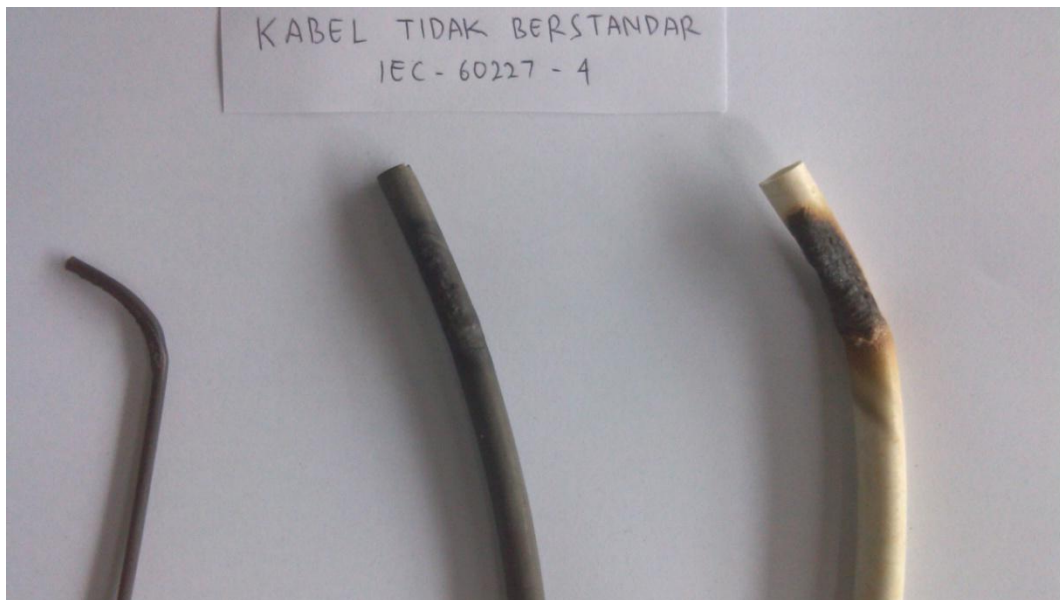
Gambar Hasil Uji Bakar Bagian Isolator, Pembungkus Inti Dan Selubung Luar Kabel NYM 3x1,5 mm 2 (Re) Tidak Berstandar IEC 60227 – 4
