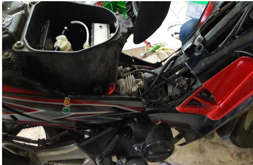
Gambar 3.7 Kendaraan Uji setelah pemasangan generator HHO
