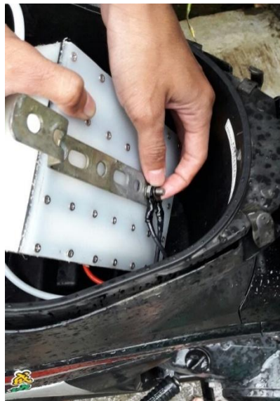
Gambar 3.10 Kabel Hitam dipasang ke generator HHO kutub negatif
