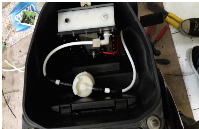
Gambar 3.11 Penempatan generator HHO di bagasi sepeda motor
