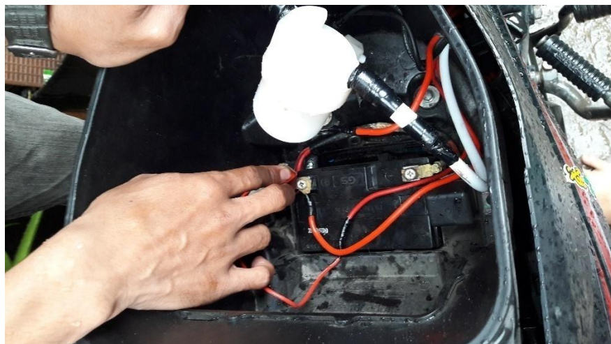
Gambar 3.8 Perakitan kabel generator HHO ke accu .
