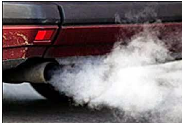
Gambar 2.8 Emisi gas buang buruk pada mobil
