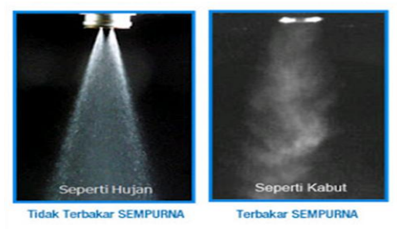
Gambar 2.4 Proses pembakaran sempurna dan tidak sempurna 6
