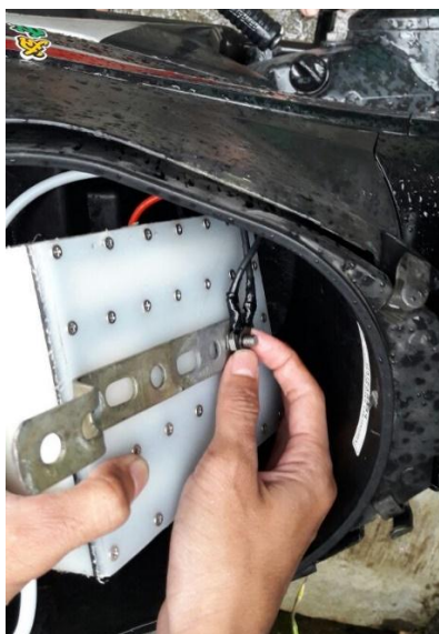
Gambar 9. Pengaplikasian Generator HHO ZCLC pada sepeda motor supra 125 cc
