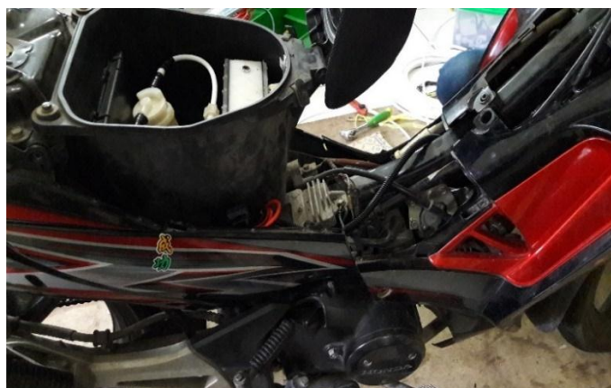
Gambar 5. Pengaplikasian Generator HHO ZCLC pada sepeda motor supra 125 cc
