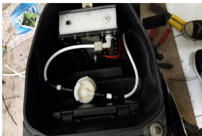
Gambar 6. Penempatan Generator HHO ZCLC pada sepeda motor supra 125 cc
