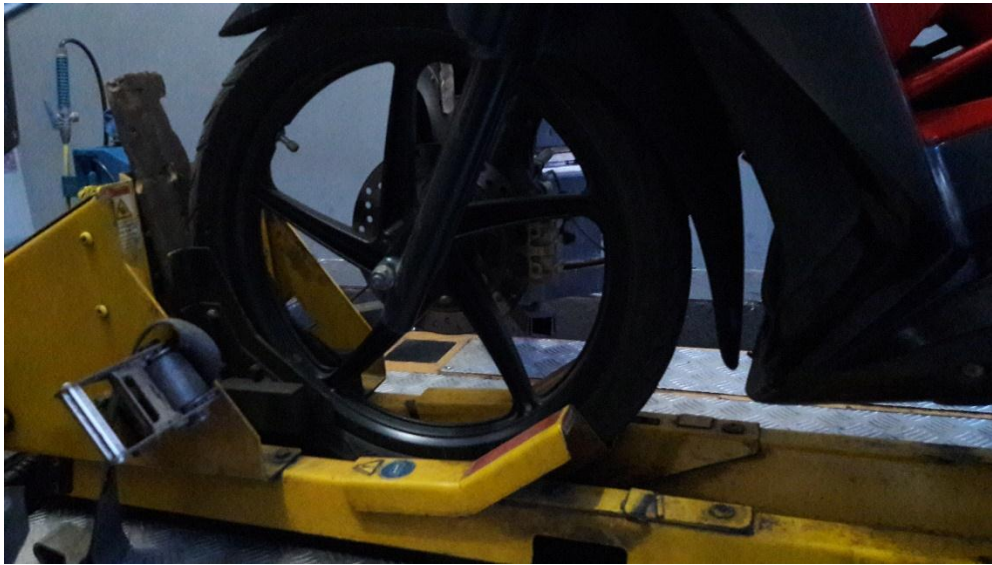
Gambar 12. Kendaraan Uji dengan posisi roda depan berada pada wheel lock dan dikunci pada Dynojet 250i
