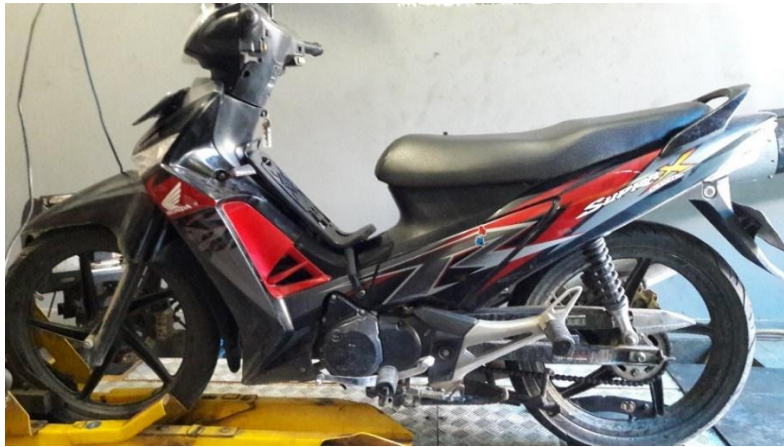
Gambar 10. Kendaraan Uji sepeda motor supra 125 cc pada Dynojet 250i
