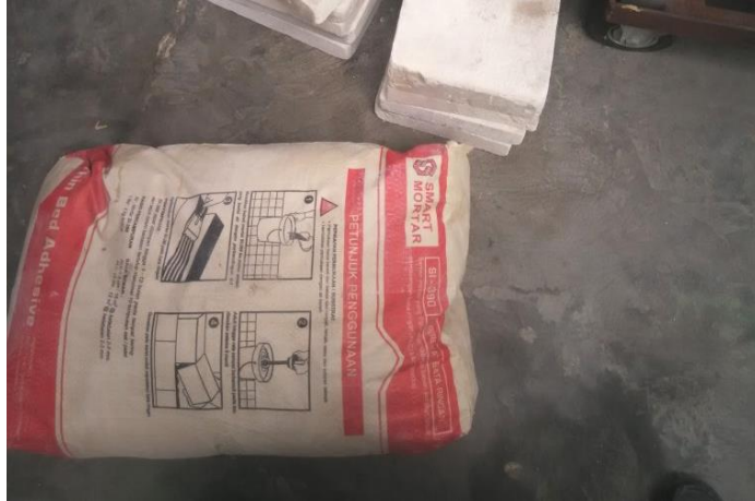
Gambar 3.6. Semen Mortar Bata Ringan
