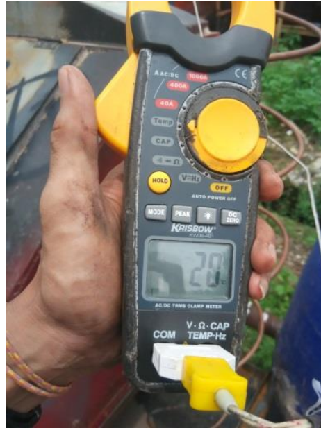
Gambar 3.55. Clam Meter untuk mengukur temperatur aliran panas
