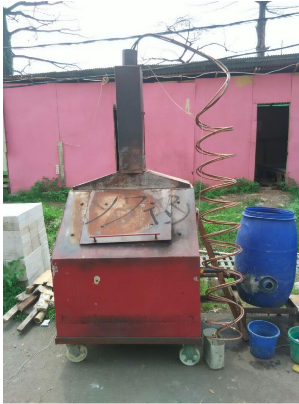
Gambar 10. Hasil rancang bangun ulang tungku alat desalinasi
