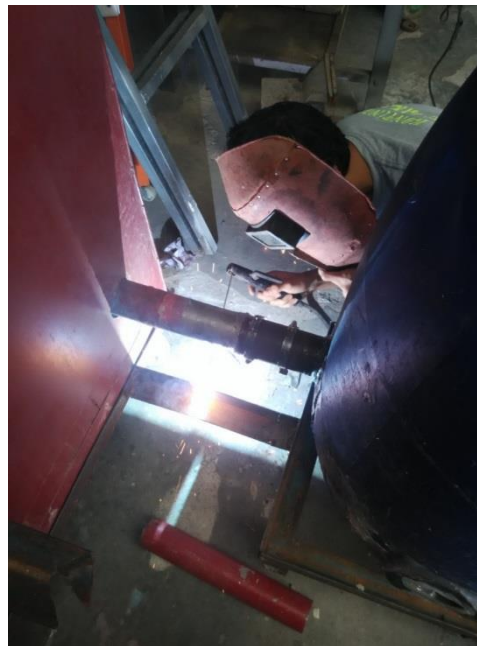
Gambar 7. Proses penyambungan saluran air bak penampungan dengan tungku alat desalinasi
