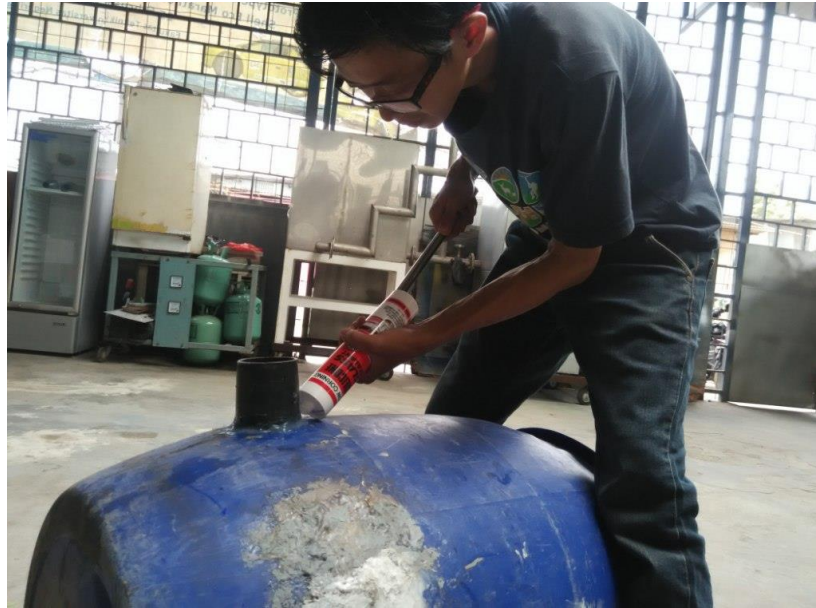
Gambar 7. Proses penambalan pada bak penampungan dengan menggunakan perekat silicon
