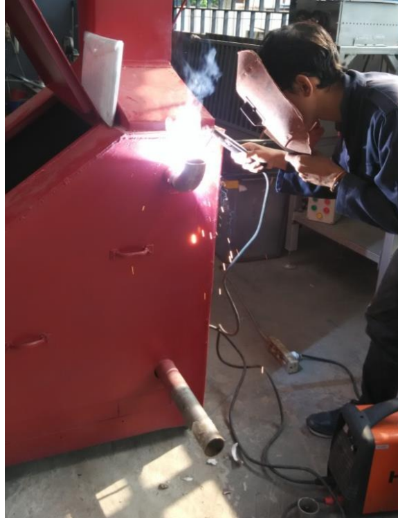
Gambar 3.1. Proses Pengelasan Menggunakan Las Listrik
