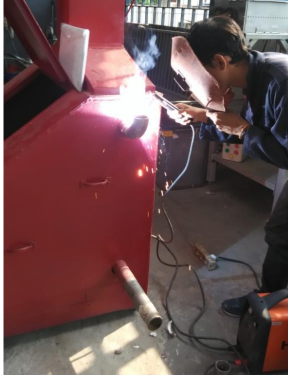
Gambar 2.6. Proses pengelasan menggunakan las listrik
