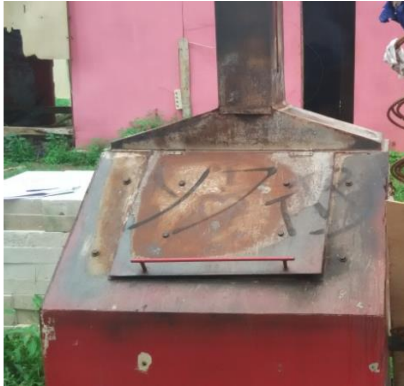
Gambar 4.15. Permukaan dinding tungku mengalami perubahan warna akibat panas yang mengalir lebih besar.
