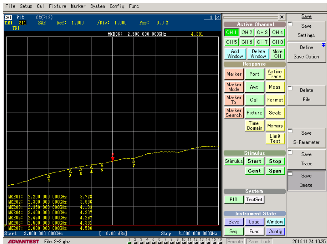
Gambar 4.32 Hasil Pengukuran VSWR Input
