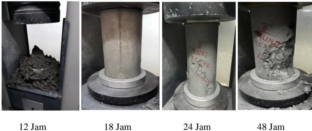
**Gambar 4.5 Pola Retak Beton Speedcrete dengan Umur 12 Jam, 18 Jam, 24 Jam, dan 48 Jam.**
