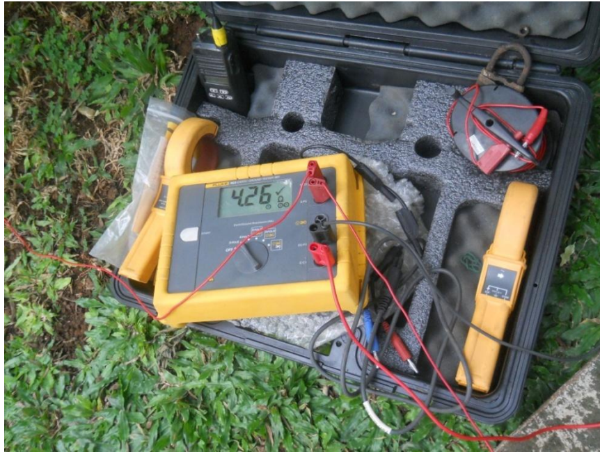
Gambar 4.21 Hasil Pengukuran Tahanan Pentanahan pada Grounding SS3
