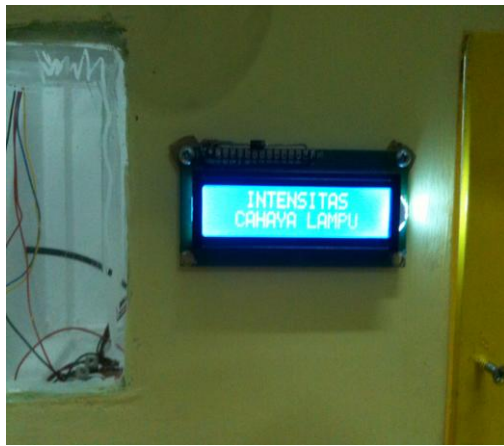
Tampilan Awal LCD Saat Catu Daya Dihidupkan
