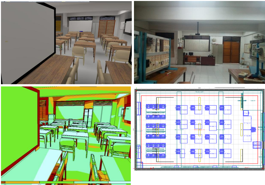
Gambar 4.20 Model 3D Simulasi Ruang R 211 dengan Model Aslinya serta Tampilan Ilustrasi Penyebaran Cahaya
