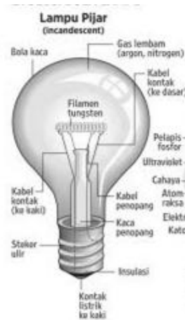
Gambar 2.11. Strukur Lampu Pijar
