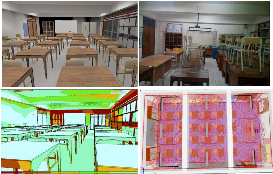
Gambar 4.10 Model 3D Simulasi Ruang R 208 dengan Model Aslinya serta Tampilan Ilustrasi Penyebaran Cahaya
