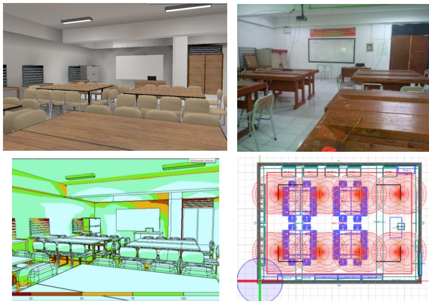
Gambar 4.15 Model 3D Simulasi Ruang R 209 dengan Model Aslinya serta Tampilan Ilustrasi Penyebaran Cahaya
