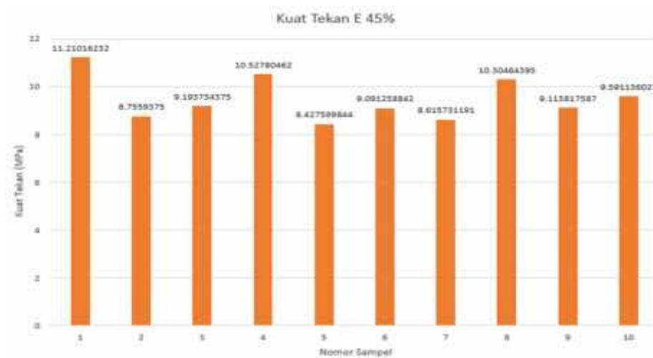
**Gambar 4.18 Histogram Hasil Pengujian Uji Tekan Kelompok Uji E**
