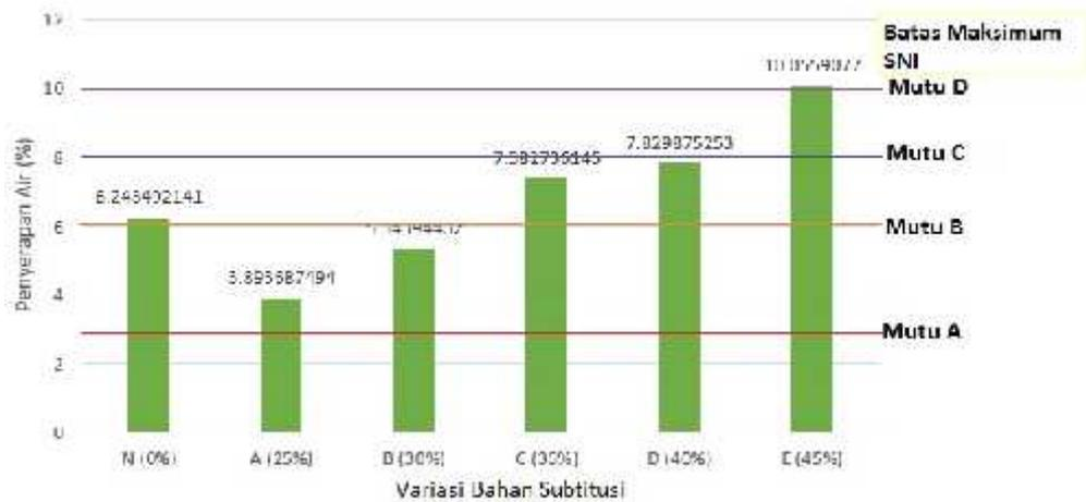
**Gambar 4.6 Histogram Hasil Pengujian Penyerapan Air Rata-Rata**
