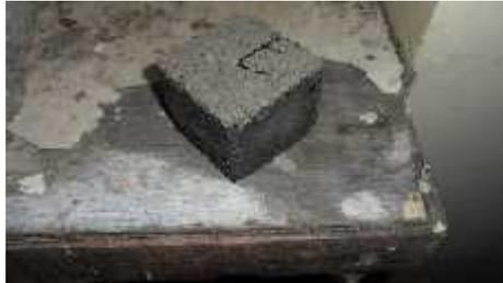
**Gambar 3.1 Ukuran Untuk Pengujian Kuat Tekan**
