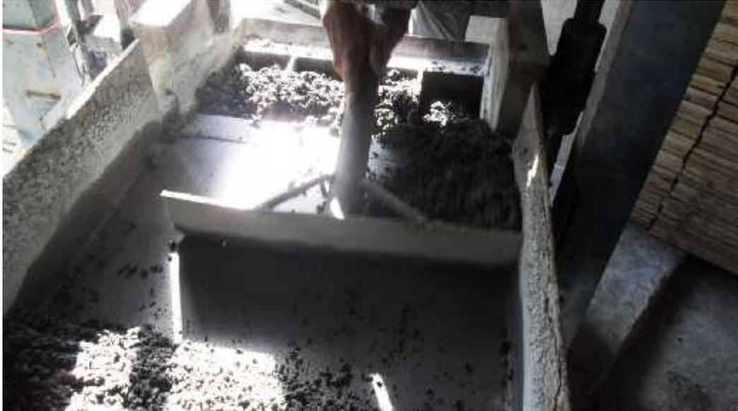
Gambar 3. Campuran dimasukkan ke dalam cetakan
