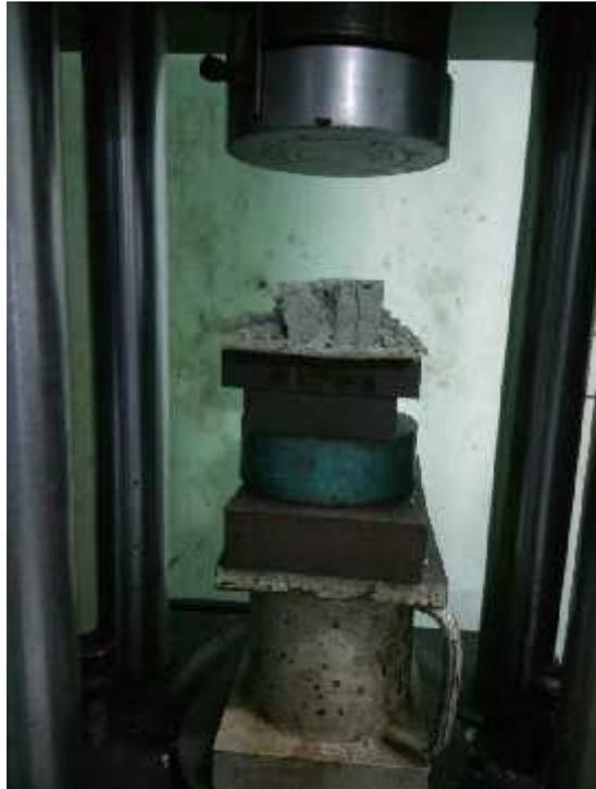
Gambar 14. Benda uji Setelah uji tekan
