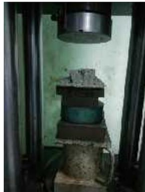
**Gambar 3.2 Pengujian Dengan Mesin Uji Tekan**
