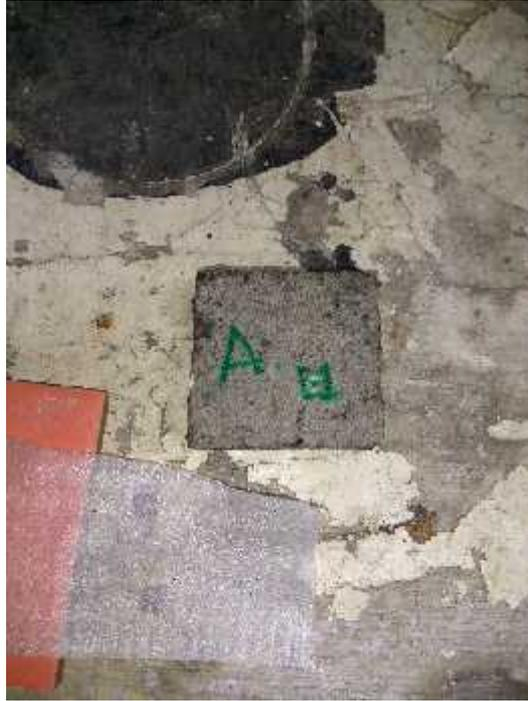
Gambar 6. Hasil Pemotongan Benda Uji Kuat Aus
