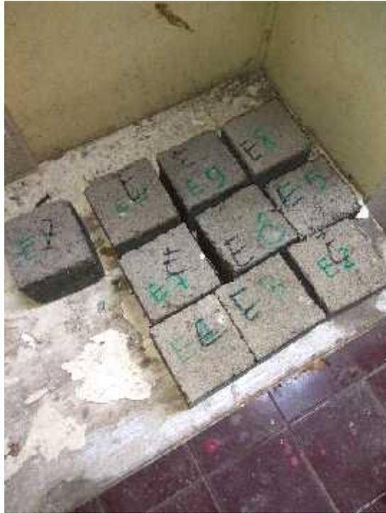
Gambar 4. Hasil Pemotongan Benda Uji Tekan
