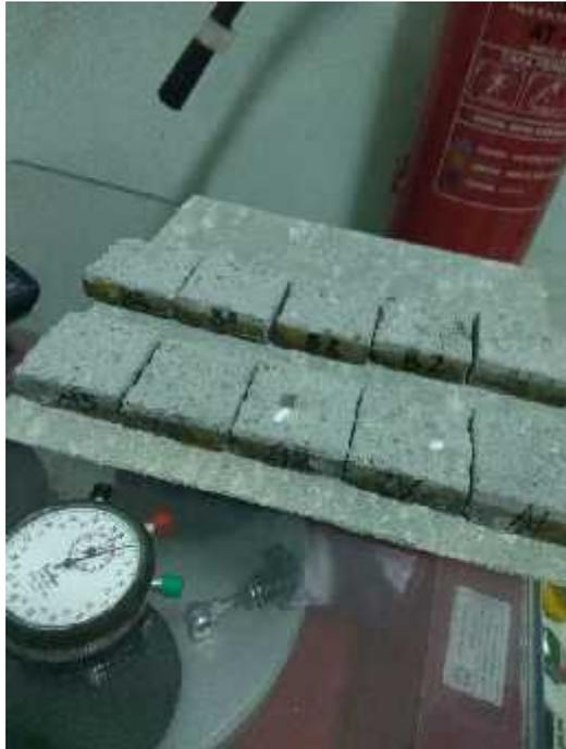
Gambar 12. Tampak lapisan atas setelah pengujian aus
