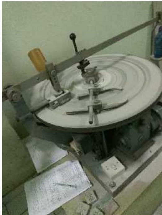
Gambar 11. Benda uji dalam proses pengausan
