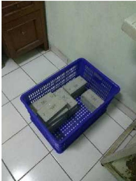
Gambar 7. Benda Uji Kering Oven
