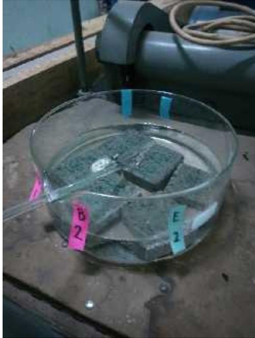
Gambar 18. Benda uji di dalam larutan natrium sulfat
