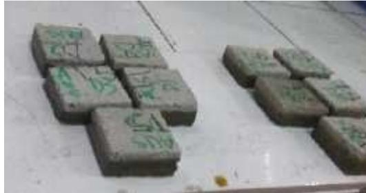
**Gambar 4.1 Ukuran Potongan untuk Pengujian Kuat Aus**
