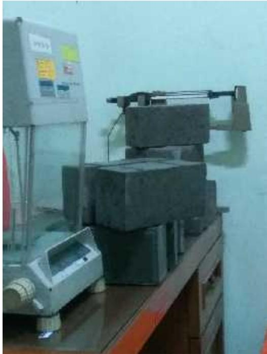
Gambar 8. Benda Uji Setelah Perendaman 24 Jam
