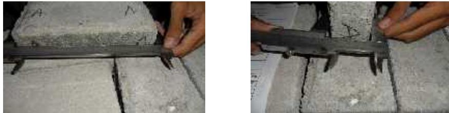
**Gambar 2.1. Pengukuran *Paving block* Tiap Sisi**
