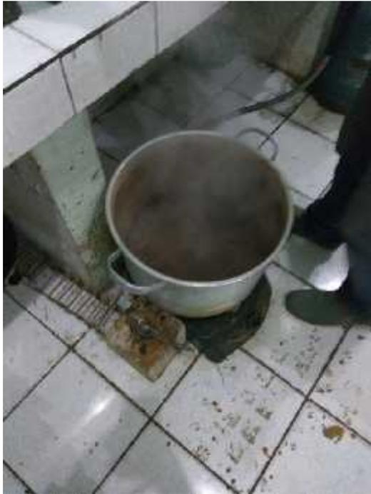
Gambar 20. Benda uji direbus dalam air selama 1 jam untuk menghilangkan natrium sulfat dalam benda uji
