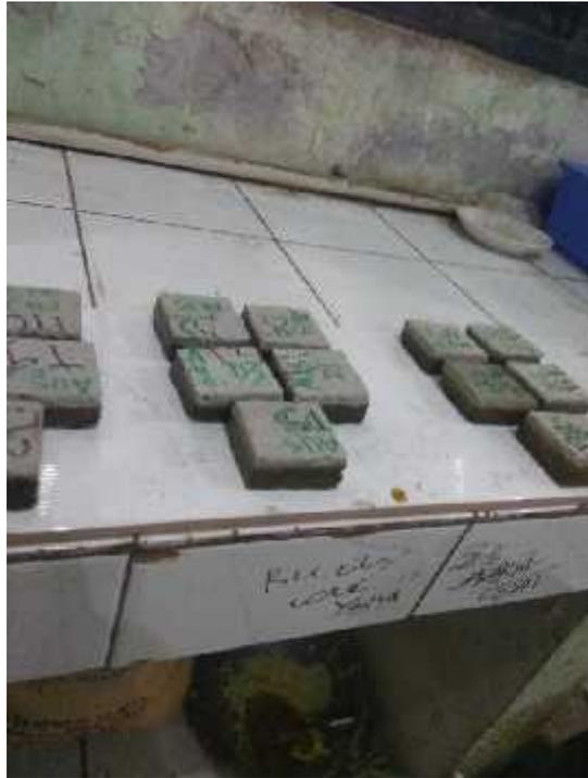
Gambar 10. Benda Uji kering oven diberikan lilin pada sisi samping dan bawah agar lapisan tidak gugus
