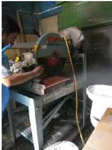
Gambar 3. Pemotongan Benda Uji
