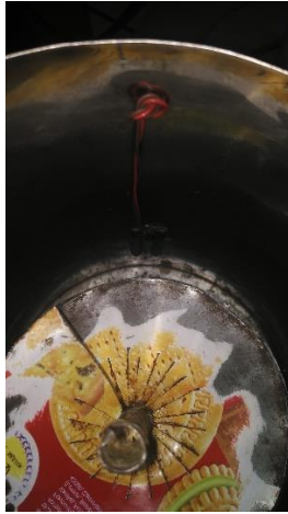
Lampiran 7 : Moisture Sensor Terletak Pada Sisi Dalam Pengering dan Pengaduk di Dalam Pengering
