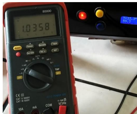
Gambar 4.3. Pengujian Tegangan Sensor Suhu Sumber : Dokumentasi
