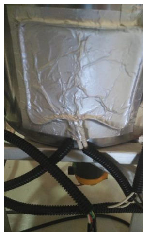
Lampiran 6 : Heater dan Sensor LM35 Terletak Pada Tabung Pengering
