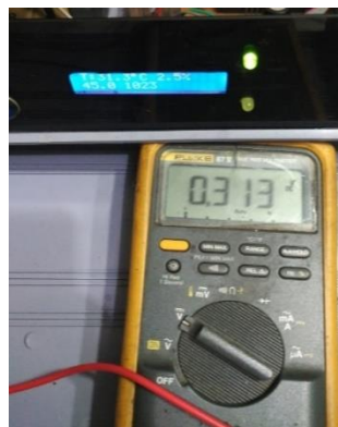
Gambar 4.4. Pengujian Tegangan Sensor Suhu Sumber : Dokumentasi
