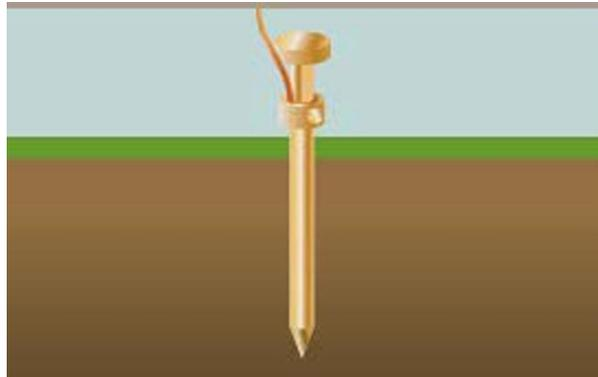
Gambar 2.26 Elektroda Batang<sup>12</sup>
