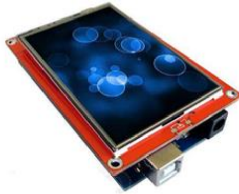
Gambar 3.9. Rangkaian Mikrokontroler Arduino Dengan Shield LCD ( Liquid Display Display ) Layar Sentuh Dan Micro SD Card Modul
