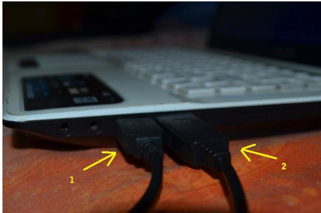
Gambar 3.18 Kabel *USB to Serial* dan Kabel *USB Webcam* Telah Terpasang pada Komputer/Laptop
