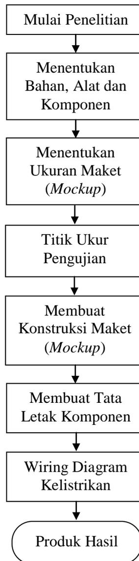
Gambar 3.1 Alur Kerja Pembuatan Sistem Keamanan Toko Berbasis Arduino yang Terintegrasi dengan PC
