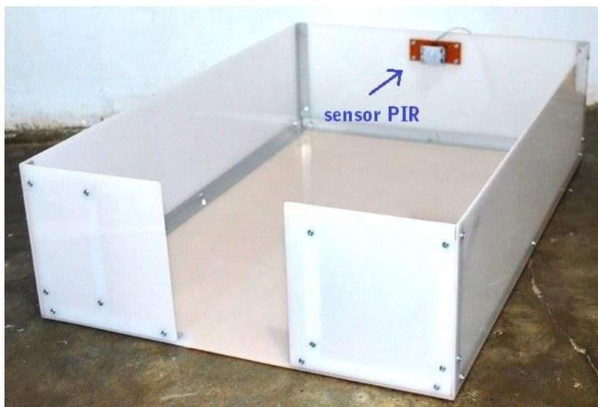
Gambar 3.32 Posisi sensor PIR pada Maket (*Mockup*)
