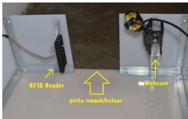
Gambar 3.31 Posisi RFID dan *Webcam* pada Maket (*Mockup*)
