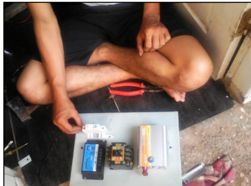
Gambar 4.6 perakitan panel kontrol
