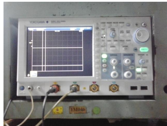
Gambar 2.4 Osciloscop DL6054 di laboratorium Gdg.3
