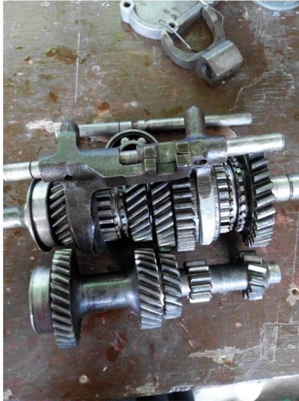
Gambar 2.15. Transmisi Posisi 3.
