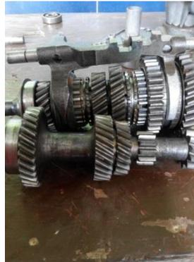
Gambar 2.13. Sistem Transmisi Posisi 1.
