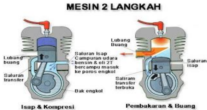
Gambar 2.3 Siklus Kerja Motor Bakar 2 Tak (Sumber : http://www.google.co.id/search )
