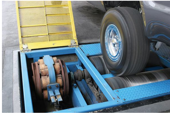
Gambar 2.10 Setup Pengujian Mesin Menggunakan Chassis Dynamometer (Sumber : www.bankspower.com )
