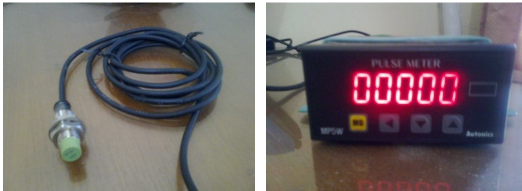
Gambar 3.5 Proximity Sensor Dan Display
