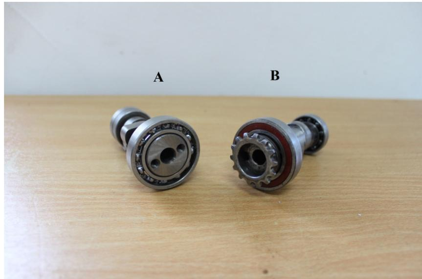
Gambar 3.6 ( A ) Posisi Pemasangan Gigi Sentris Standar ( B ) Posisi Pemasangan Gigi Sentris Baru Pada *Camshaft*
