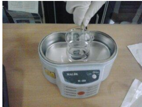
Gambar 3.7 Membersihkan Substrat dengan Ultrasonic Cleaner
