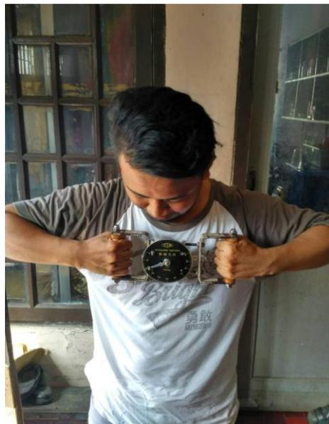
**Gambar 16.** Gerakan mengukur kekuatan dengan menggunakan alat dynamometer
