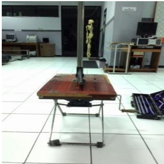
Gambar2.3 Alat untuk mengukur tinggi duduk Sumber : Dokumentasi Pribadi
