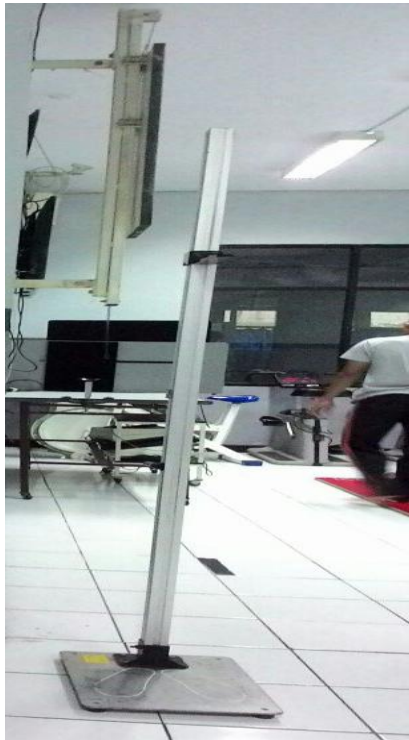
Gambar 2.1 Alat untuk mengukur tinggi badan Sumber : Dokumentasi Pribadi
