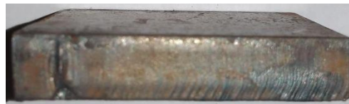
Gambar 4.10 Hasil Pemotongan pertama dengan pelat 10 mm menggunakan cutting speed 490 mm/menit.
