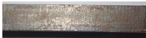
Gambar 4.9 Hasil Pemotongan ketiga dengan pelat 10 mm menggunakan cutting speed 650 mm/menit
