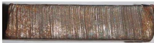
Gambar 4.12 Hasil Pemotongan ketiga dengan pelat 10 mm menggunakan cutting speed 490 mm/menit.
