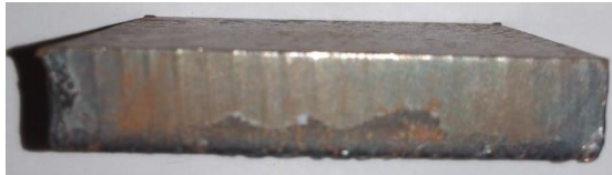
Gambar 4.13 Hasil Pemotongan pertama dengan pelat 10 mm menggunakan cutting speed 520 mm/menit.
