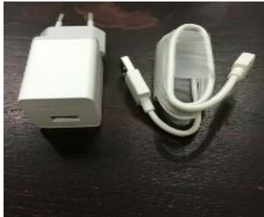
Gambar 9. Adaptor 5v dc Sumber : http://itcermat.com/mengenal-perangkat-arduino/
