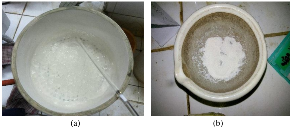
Gambar 29. (a) Bubur Silika Gel ( Slurry ) Setelah Dicuci, (b) Silika Xerogel
