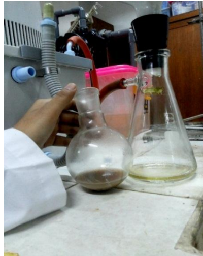
Gambar 24. Filtrat Hasil Penyaringan Larutan Natrium Silikat
