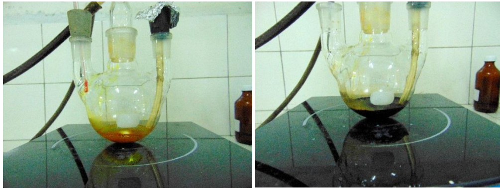
Gambar 34. Sintesis Magnetit. (a) Larutan FeCl 3 .6H 2 O Ditambah FeCl 2 .4H 2 O dan Sebelum Ditambah NaOH 1 M, (b) Setelah Ditambah NaOH 1 M
