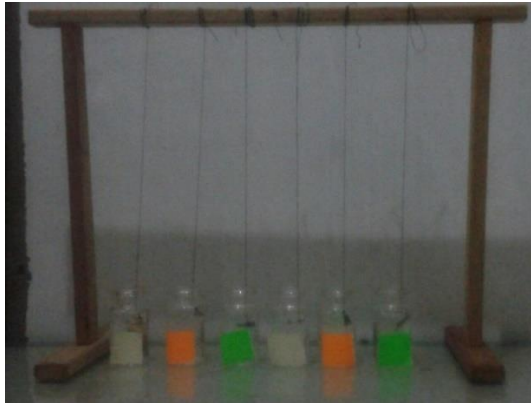
Gambar 4.13. Pengujian Korosi pada Substrat Baik yang Dilapisi Maupun Tidak Dilapisi Lapisan Komposit Ni-TiAlN
