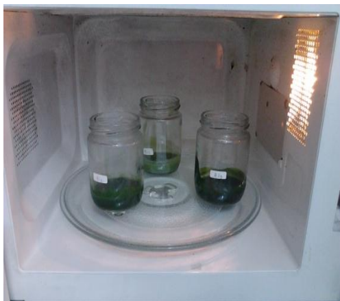
Gambar 5.13 Pemecahan dinding sel dengan microwave
