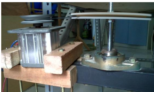
Sistem Puli dan Generator
