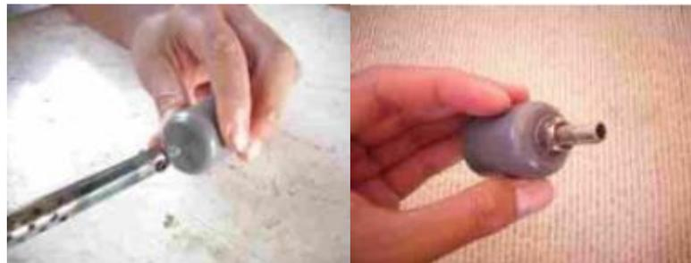
**Gambar 4.7** Membuat sambungan bunglon-dop
