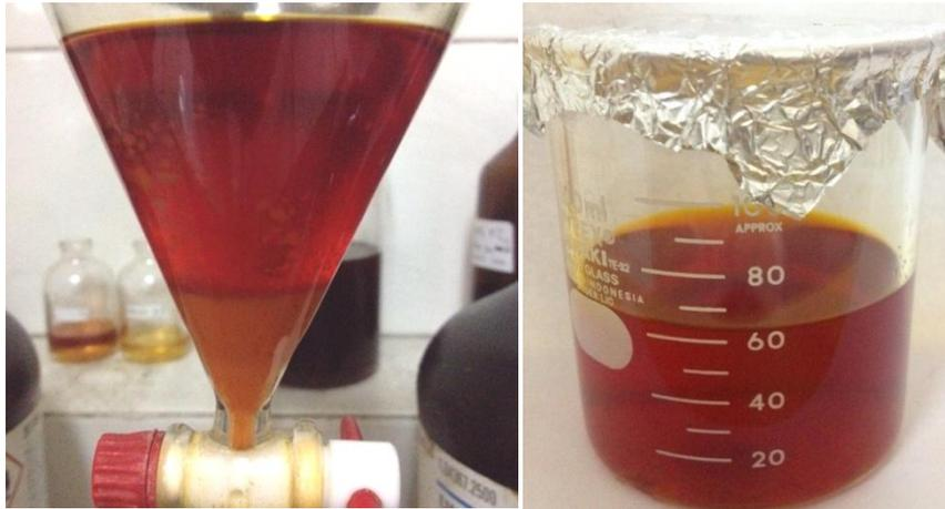
Gambar 12. a) Hasil ekstrak yang terdiri dari dua fasa, b) Fasa etil asetat yang telah ditampung
