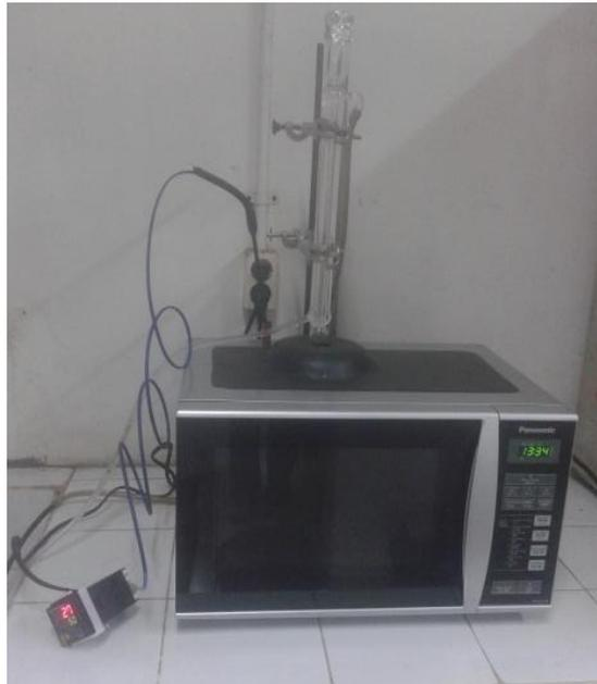
Gambar 11. Oven Gelombang Mikro yang telah dimodifikasi
