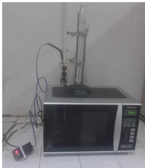
Gambar 1. Oven gelombang mikro yang telah dimodifikasi
