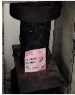
Gambar 4.9 Uji Kuat Tekan Beton 0% Tidak Dioven (1B)
