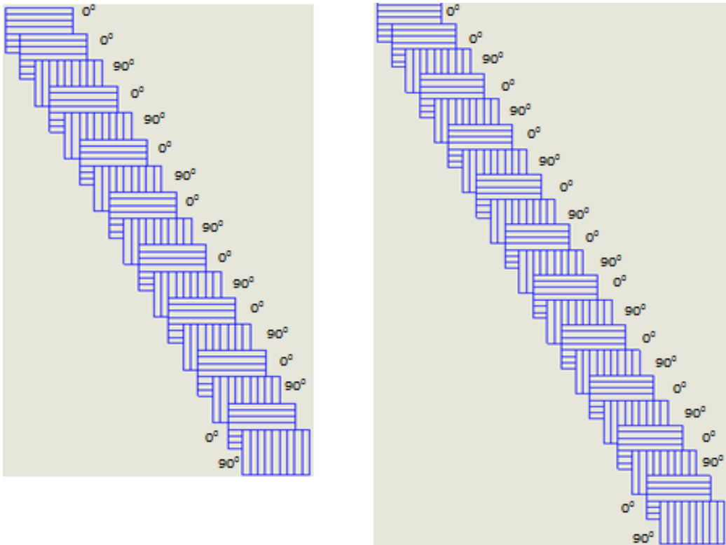
Gambar 3.16. Sudut orientasi pelapis 0^\circ, 90^\circ dengan variasi jumlah lapisan 17 dan 21
