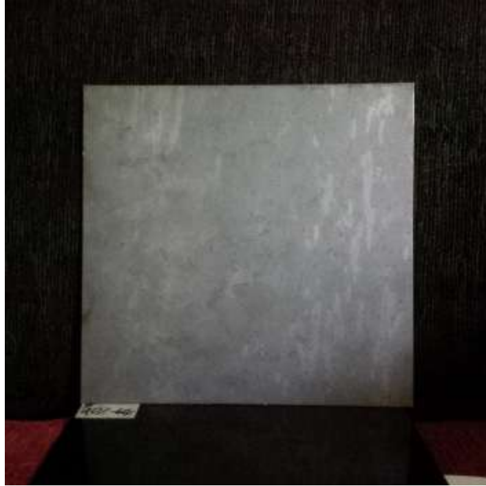
1. Plat Siap Untuk Diaplikasikan Dengan Epoxy
