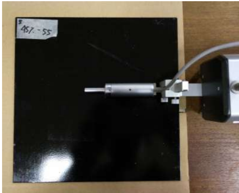
Salah Satu Pengujian Dengan Alat Roughness Test
