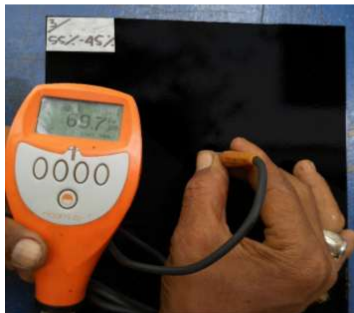
Salah Satu Pengujian Dengan Alat Thickness Gauge
