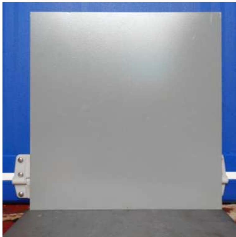
4. Hasil Setelah Epoxy Priemer Kering Dan Siap untuk Diaplikasikan Dengan Cat Water
