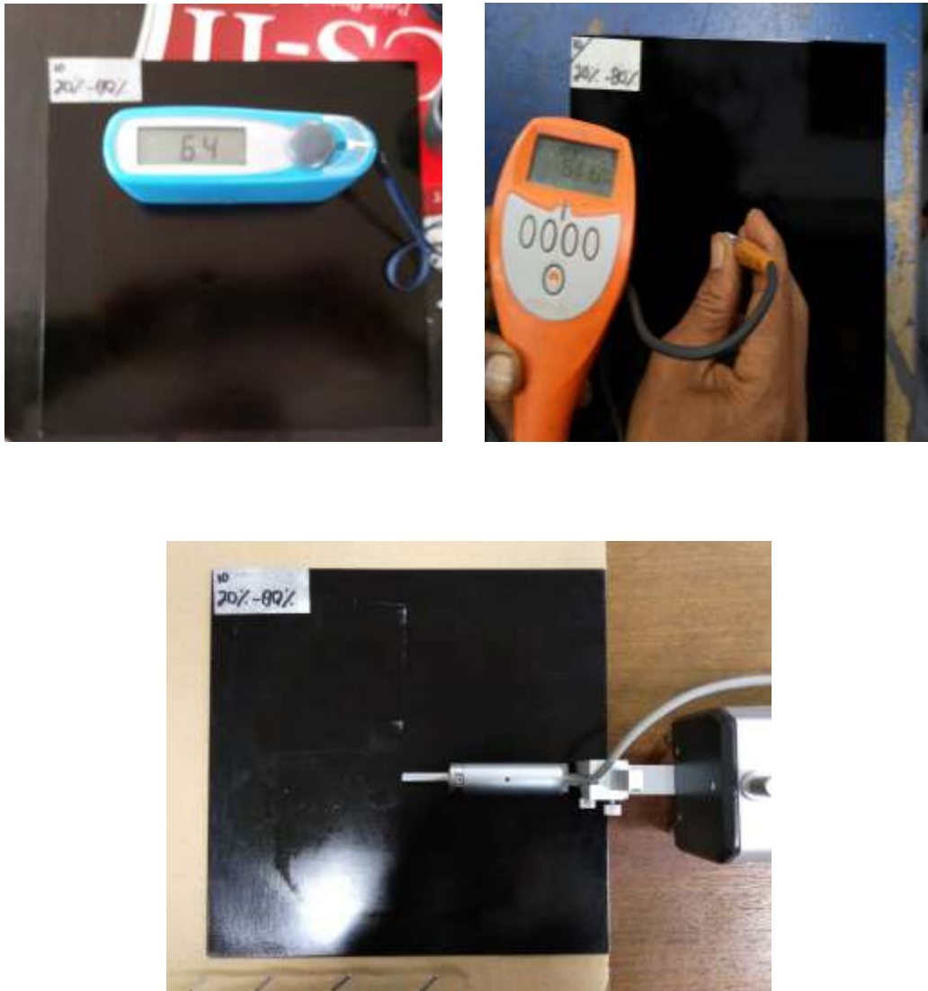
Gambar 4.21 Untuk kilapnya didapat 64 Gloss Unit, ketebalannya 54,6 \mu\text{m} dan pengambilan data kekasaran permukaan cat pada plat sampel 10.
