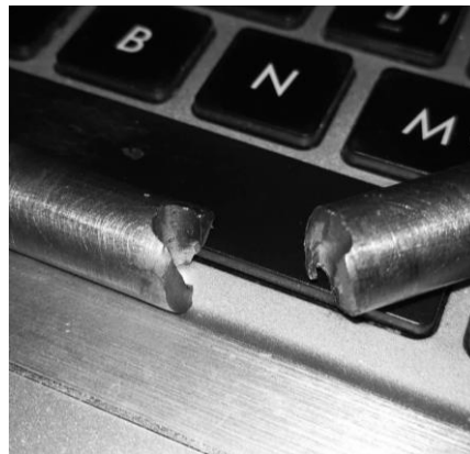
Gambar 1.1 Kegagalan pada poros Final Drive
