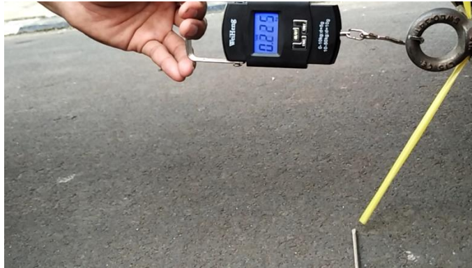
Gambar 3.4 Mengukur gaya hambat rolling kendaraan
