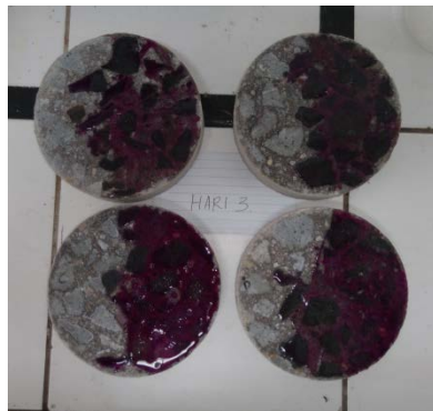
Gambar 4.6 Permukaan Tengah BioConcrete Bersifat Basa
