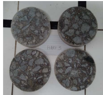
Gambar 4.7 Permukaan Bawah BioConcrete Bersifat Asam
