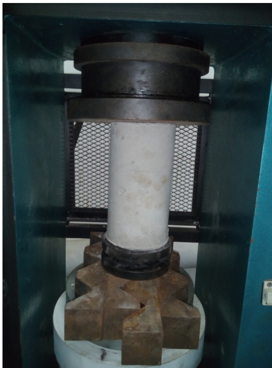
Gambar 4.1. Pengujian Kuat Tekan Beton.
