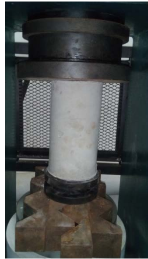
Uji kuat tekan
